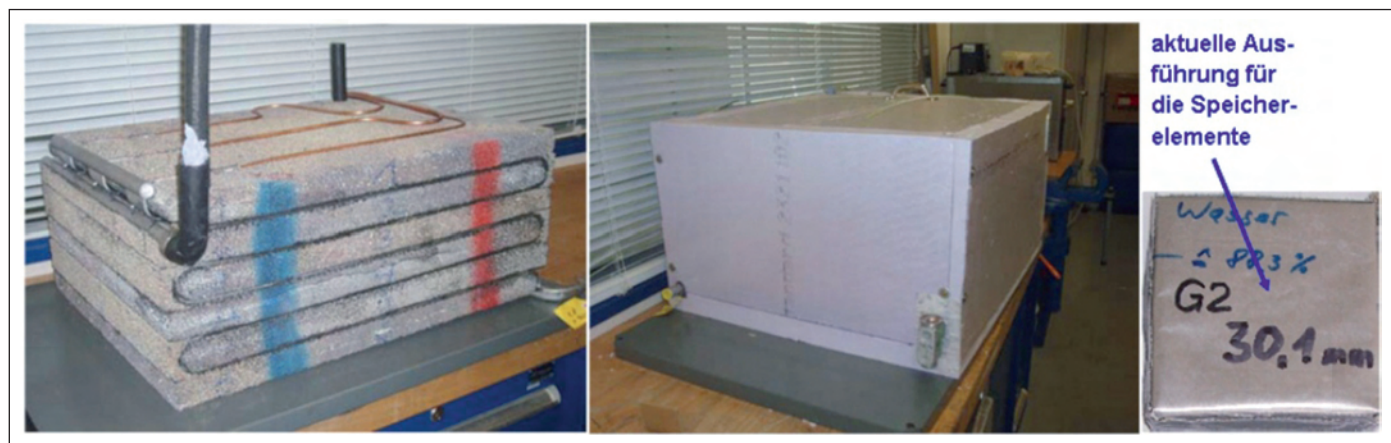
Bild 6: Latentspeicher mit Metallschaum-Wärmeübertrager (links) für die mobile Anwendung; PCM: Wasser.
