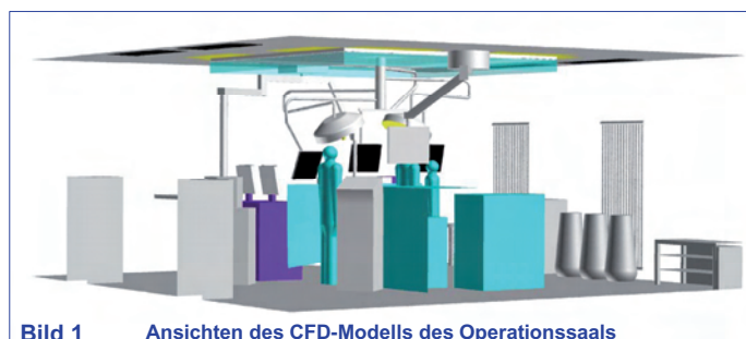
Bild 1 Ansicht des CFD-Modells des Operationssaals
