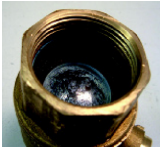
Bild 3: Kugelhahn in Eckform mit Schäden am metallischen Überzug der Kugel.
