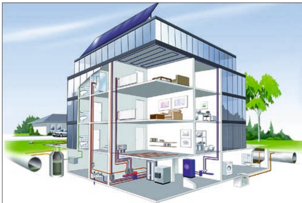
Abb. 3: „OVplan“ ermöglicht die Anlagenberechnung Rohrnetz, Heizung, Kühlung, Trinkwasser und Flächenheizkreise.
