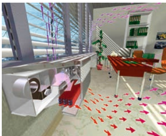
Zu- und Abluftbrüstungsgerät mit integriertem Wärmeaustauscher.
