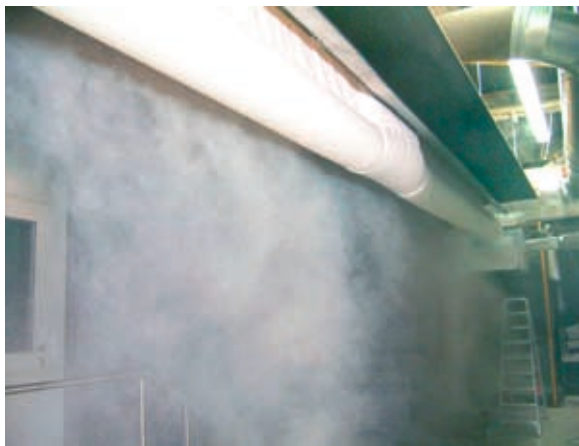
Bild 11: Sichtbare Sperrwirkung der Luftwand unter einem "Brandschutz-Airbag".
