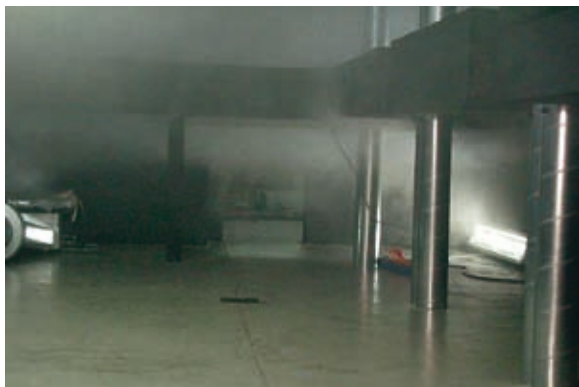
Bild 3: Verrauchung des Saales durch den Zuluftimpuls ( u = 1,54 \text{ m/s} ).
