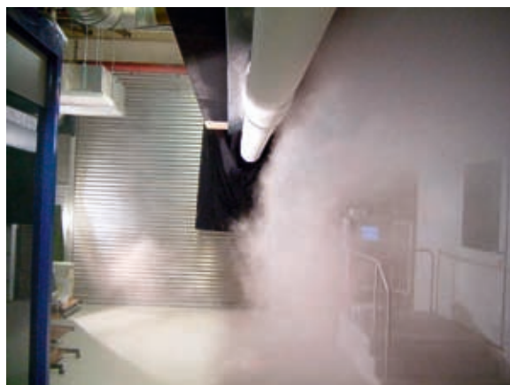
Bild 10: Versuche mit dem „Brandschutz-Airbag“ – sichtbare Sperrwirkung bei Untertemperaturen.
