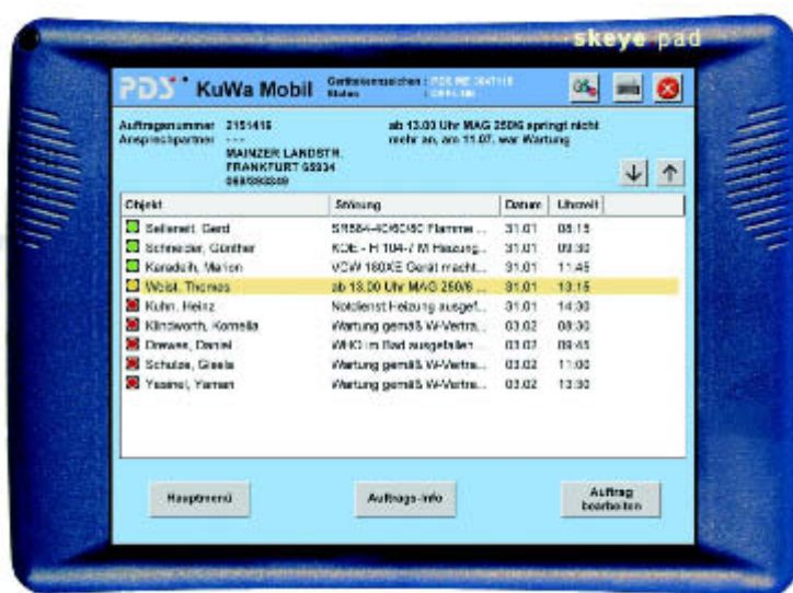
1. Kundendienst/Wartung: Das skeye.pad für den Monteur im Außendienst enthält alle Auftragsdaten sowie die Reihenfolge in der Tourenplanung.
