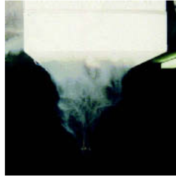
Bild 8: Strömungsbeispiel passiver Deckenkühlkonvektor.
