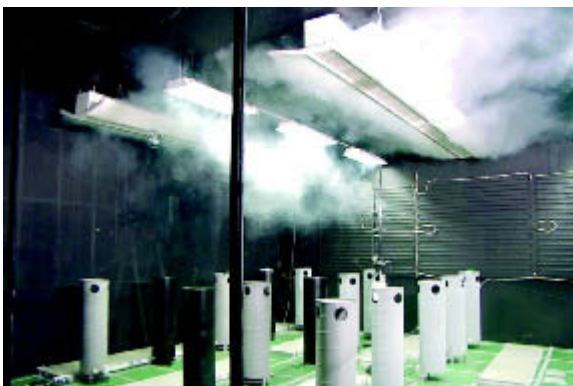
Bild 21: Aktiver Deckenkühlkonvektor im Labortest.
