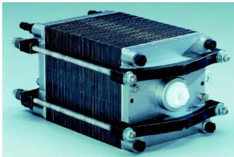
Bild 4: PEM-Brennstoffzellen-Stack (frühere Bauart)
