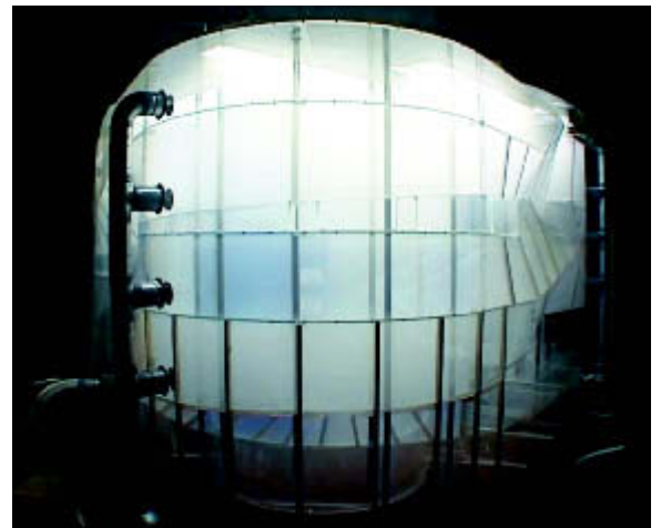
Bild 9: Rauchausbreitung im gesamten Museumsbereich
