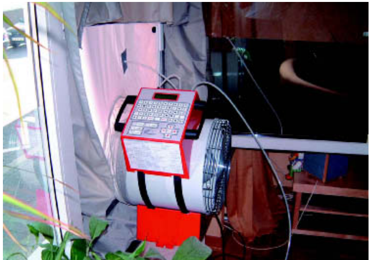
Messung der Luftdichtheit mit dem Blower-Door-Test eingebaut in ein Wohnzimmerfenster
