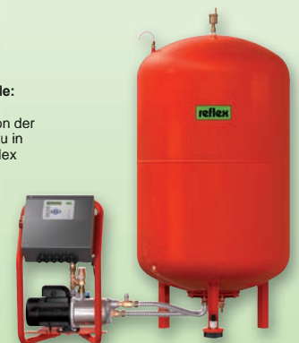
reflex 'variomat': Die innovative, pumpengesteuerte Druckhaltestation mit zusätzlicher Nachspeise- und Entgasungsfunktion.
