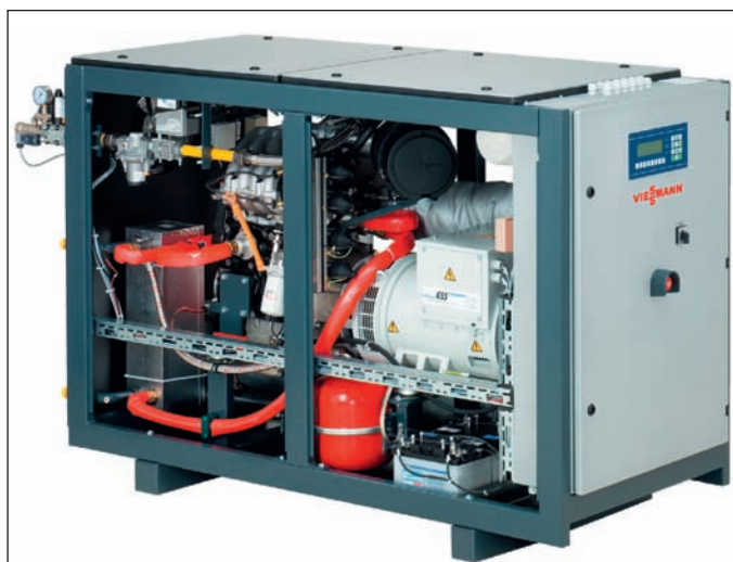
Bild 5: Ein gasbetriebener Vier-Zylinder-Motor treibt im Mini-BHKW Vitobloc 200 EM-18/36 einen Synchrongenerator zur Stromerzeugung an. Durch die Brennwertnutzung der Abgaswärme wird ein Gesamtwirkungsgrad von 96,4 Prozent erreicht.
